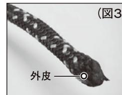
外皮をライター等で溶かし、軍手をはめた指先で袋状に閉じて硬化した後、芯材が見えていないことを確認する。
