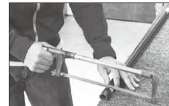
①シャフトの切断位置にペンやマスキングテープなどで印をつけ、FRP用のこぎりで切断します。パイプ用のソーガイドを使用すると正確にカットできます。
