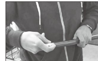
②切断面のバリをサンドペーパーで滑らかにします。その後、シャフトの内側（約5cm）とグリップの接続部分をサンドペーパーで粗らして接着剤がのりやすくなります。
