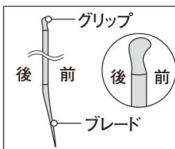
⑤接着剤が硬化する前にブレードとグリップが同じ角度になるように調節し、はみ出した接着剤を取り除きます。
