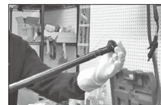
④熱収縮チューブシャフトに通し、グリップをシャフトに挿入します。その際グリップの前後に注意してください。接着剤は接続部分の隙間を覆い防水性がでるようにします。
