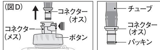
※チューブを取り外した際にチューブの先のパッキンが脱落していないか必ず確認してください。パッキンは消耗品です。チューブを接続しても漏水するようになったらパッキンを交換してください。
