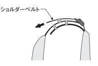
※ショルダーベルトが長い場合は、調節テープを 一度バックルから抜き、ベルトループ①に通さずに セットすることでより短くできます。
